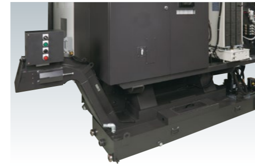
Транспортер для удаления стружки
