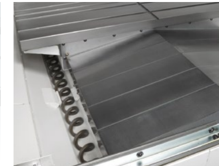
Встроенная система удаления стружки (спирального типа)
