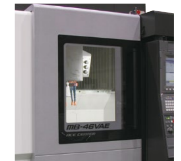
Полностью герметичный защитный кожух
