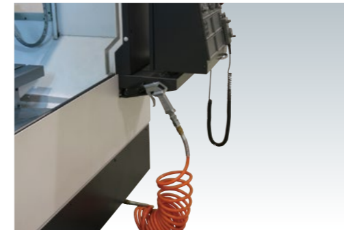
Пистолет СОЖ для промывки деталей
